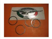
Rondelle d'épaisseur Entre le pignon de 5° d'A.S. Et le joint torique
