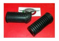
Diam. Intérieur : 21 mm Avec languette intérieure Diam Extérieur : 39x41 mm Longueur : 95.5 mm Avant: V 35 III
