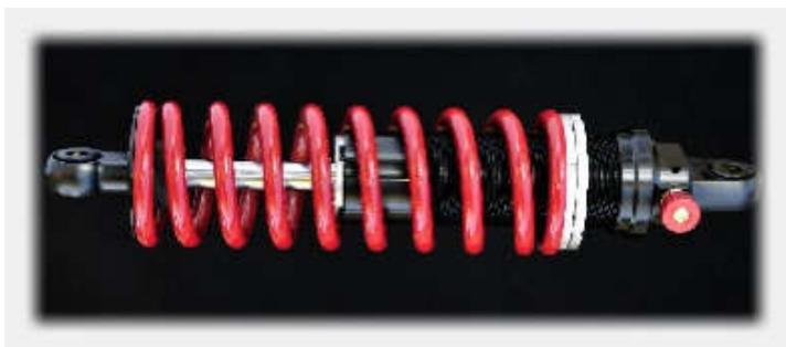
**Mono-amortisseur** à gaz, réglable en hydraulique mais également en précontrainte du ressort pour agir sur hauteur de la machine.
