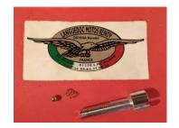
Vis de réglage du câble d'embrayage
